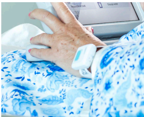
Polsband met alarmering en positiebepaling gekoppeld aan het Ascom platform en het EPD
