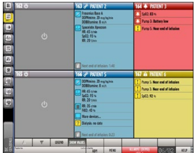
Une capture d'écran de Digistat® Smart Central montrant 6 lits avec les signes vitaux des patients fournis par les moniteurs, les ventilateurs, les pompes à perfusion ainsi que certaines alarmes et avertissements.
