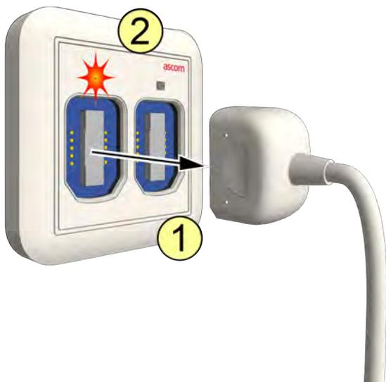
1. L'une des fiches connectées à un câble intelligent pour dispositif médical est déconnectée du serveur de ports.
