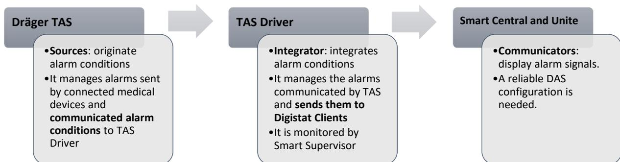
Das TAS kommuniziert mit dem TAS-Treiber über die TAS-APIs Version 1.1 die Alarmbedingungen der mit dem TAS-Netzwerk verbundenen Geräte (bis zu 100 Geräte pro TAS). Der TAS-Treiber unterstützt eine verschlüsselte Verbindung und Authentifizierung gemäß den TLS 1.2 Sicherheitsanforderungen und die Korrektheit der Nachrichten wird durch das TCP/IP-Protokoll gewährleistet.
