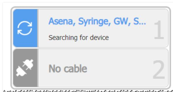
Diese Ansicht bleibt unverändert, bis Daten vom Gerät empfangen werden. Wenn beispielsweise das Gerät ausgeschaltet wird, zeigt der Bildschirm der MDI Web-App das gleiche Symbol, bis das Gerät eingeschaltet wird.
