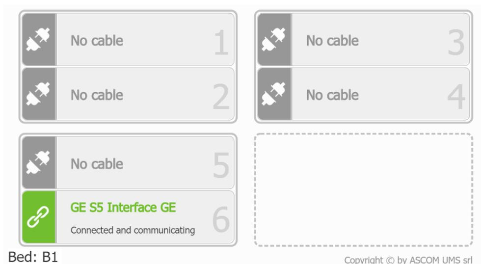
Es ist jedoch möglich, das Gerät/Kabel zu trennen, indem Sie den Magnetstecker nur physisch von der Telligence Mitarbeiterstation entfernen, ohne die Trenntaste zu drücken. Die MDI Web-App betrachtet diese Situation als „unbeabsichtigte Trennung“. Der MDI Web-Hauptbildschirm verändert sich daraufhin folgendermaßen:
