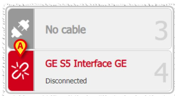
La tuile correspondant au port/câble déconnecté accidentellement est d'une couleur différente. De plus, l'icône spécifique
