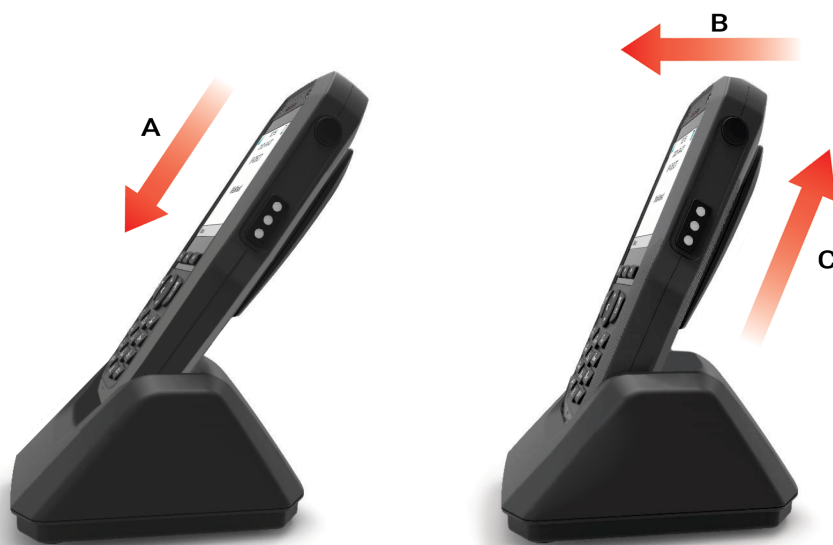
Figur 3. Eksempel på hvordan du plasserer og fjerner håndsettet fra bordladeren
