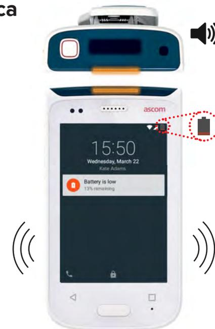
Se il livello di carica della batteria è sceso al 5 % o meno, ricaricare la batteria immediatamente.
