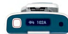
In caso di numerosi avvisi non gestiti, il display superiore fornisce una visualizzazione rapida degli avvisi in arrivo ordinati per priorità. Quando tutti gli avvisi sono stati visualizzati una volta, viene visualizzato nuovamente quello più datato e con la priorità più elevata.
