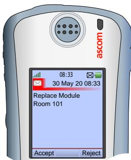
L'entrée continue à fonctionner normalement, mais la connexion correcte au dispositif médical primaire ne peut être garantie. Si vous continuez à utiliser une entrée usée, le personnel technique désigné recevra un message « Remplacer module » toutes les 20 connexions à cette entrée.
