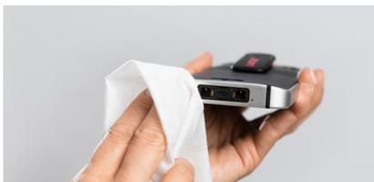
Abbildung: Reinigung der Ladekontakte bei Myco3.
